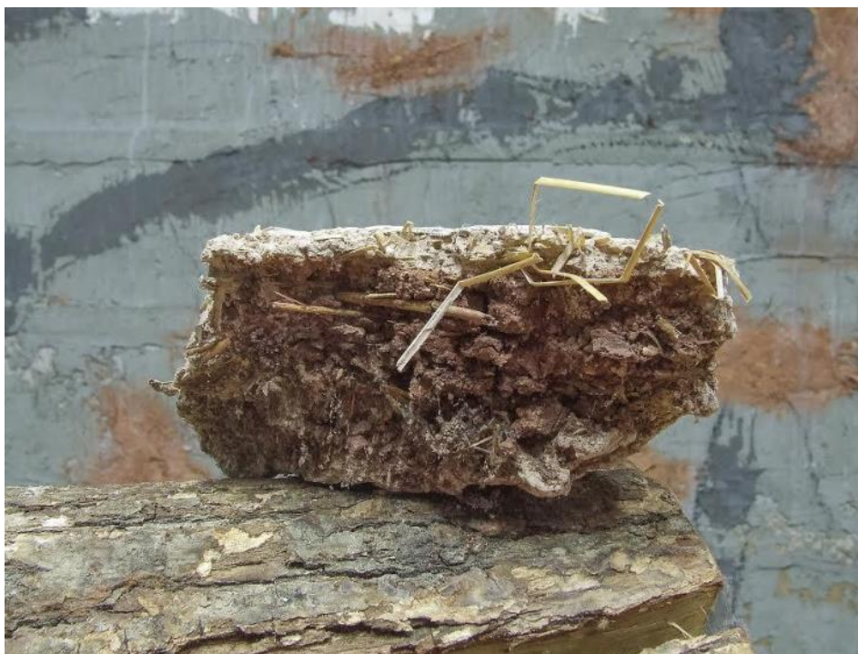
Слика 207 Испитивање структуре зида. Фрагменти зида куће зидане од блата 1922. године
