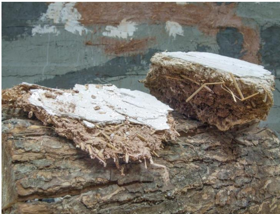
Слика 206 Испитивање структуре зида. Фрагменти зида куће зидане од блата 1922.године
